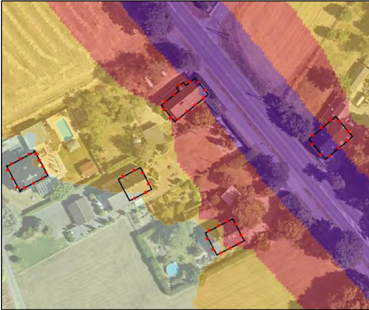
Abbildung 5: Lage der Berechnungspunkte (rot) um die Fassaden von Wohngebäuden in einem lärmkartierten Straßenabschnitt
